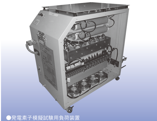
●水素発電機 試験装置用可変負荷装置
