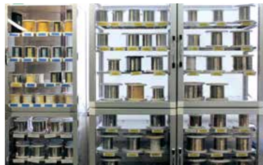
▶ デシケーターの中の線材
