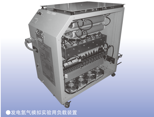
●氢气发电机 实验装置用可变负载装置
